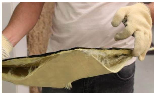
Placa delaminada após testes no Centro de Inovação e Tecnologia em Paulínia
