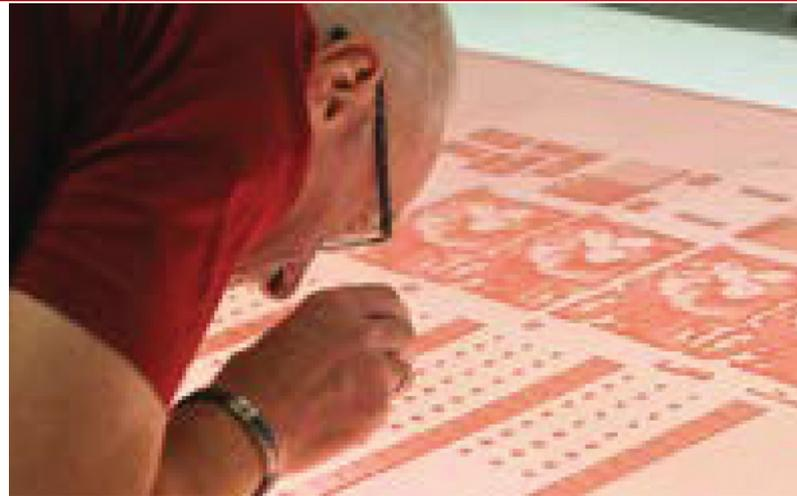
**A chapa Cyrel® NowS é uma chapa com ou sem capa na superfície, de alta dureza , que oferece uma resolução de imagem superior e uma resistência notável ao ozônio e ao desgaste. Os resultados de impressão provam uma excelente performance na transferência de tinta.**
